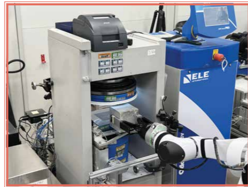
Automated Concrete Cube Testing System 自動混凝土磚測試系統
