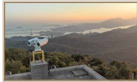
Automated Hill Fire Surveillance System 自動山火監控系統
